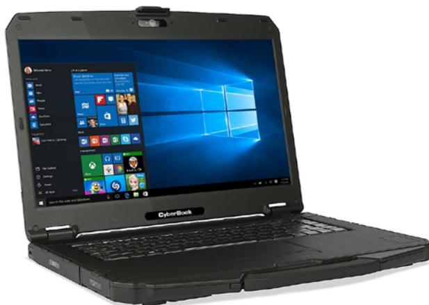
**CyberBook S895** сочетает в себе вычислительную мощность и производительность наряду с защитными функциями для обеспечения надежности работы в полевых условиях. Устройство имеет большой 15,6-дюймовый дисплей высокого разрешения HD (1920x1080), оперативную память до 16 Гб, расширенные функции безопасности. Благодаря конструкции из магниевого сплава и соответствия военным стандартам защиты ноутбук CyberBook S895 предназначен для эксплуатации в самых суровых условиях.
